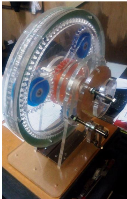
Gambar 6. Produk hasil pengembangan media realia planetary gear unit
